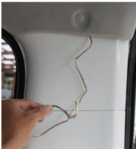
窓側、リア側のウェザーストリップを外し
