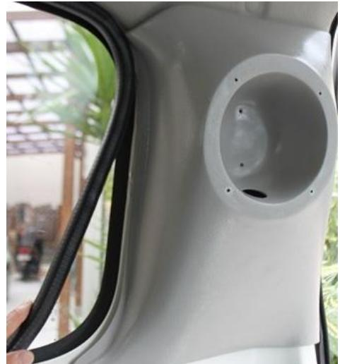
軽く手で押さえながらDピラーをセットし窓側、リア側のウェザーストリップで固定します
